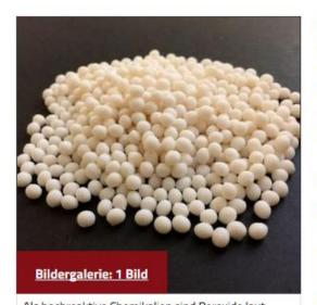
Als hochreaktive Chemikalien sind Peroxide laut Polyvel Europe aus der Polymer Verarbeitenden Industrie nicht mehr wegzudenken. Durch die Beimischung zu Recycling-Polyethylen ließe sich der Melt Flow Index (MFI) absenken, damit die gewünschten niedrigviskosen Fließeigenschaften für die Folienextrusion, das Blasformen und das Extrusionsblasformen erreicht werden können. Fakuma Halle B4 Stand 4502. (Bild: Polyvel)
