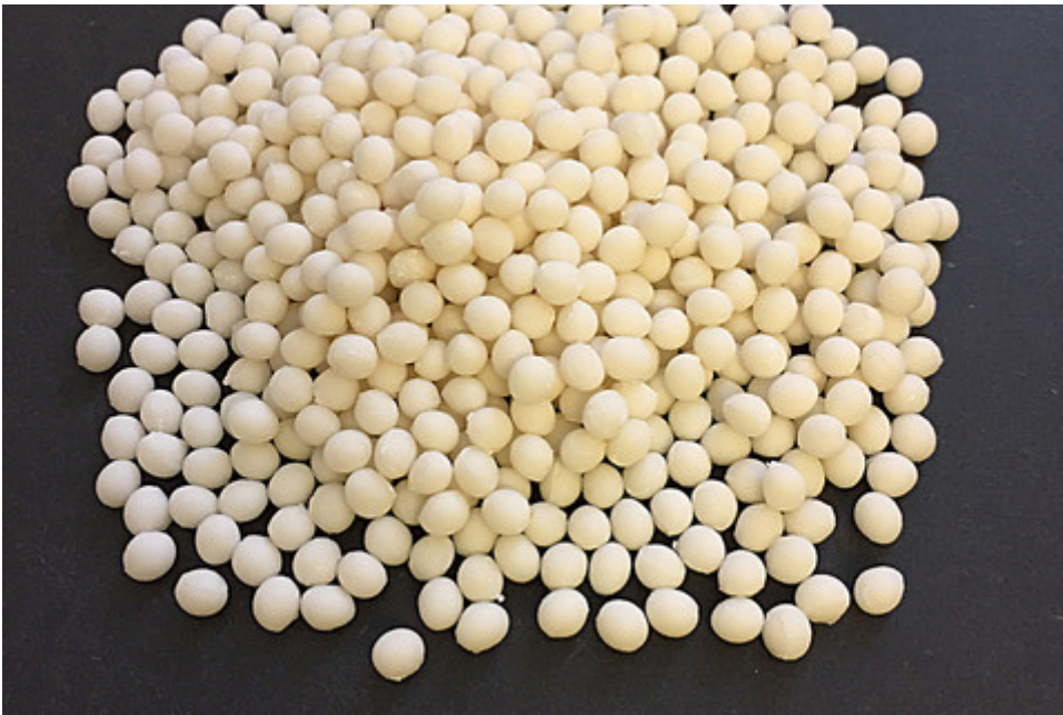
Ein Masterbatch erleichtert Lagerung, Handhabung und Dosierung von Peroxid zur besseren Verarbeitung von Polyolifinen
